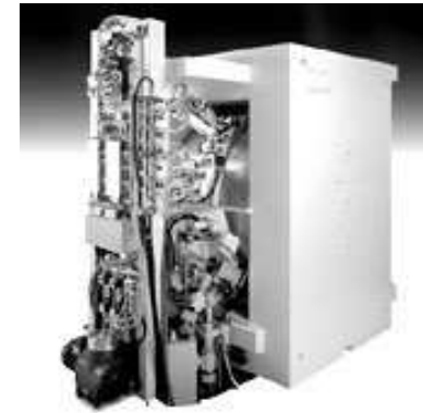
Ciclotrón PET Trace de GE (proton + deuterón)
