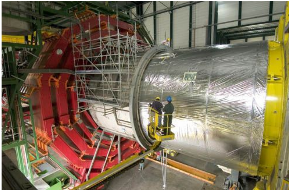
Figura 3.6: Solenoide magnético en el momento de su ensamblaje. Tomado de [29].
