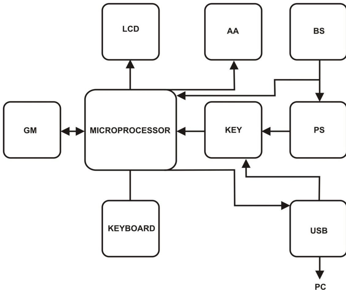
**Figura 1.3 – Esquema de bloque del instrumento**
