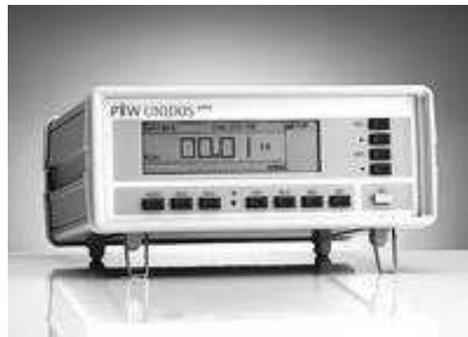
Electrómetro moderno (PTW) con lecturas de fC hasta nC. Normalmente incluyen la fuente de HV de polarización de hasta (300V ó 400V) para la cámara de ionización.
