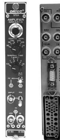
El estándar NIM (Nuclear Instrumentation Module) define un sistema modular basado en un bus de alimentación únicamente.
