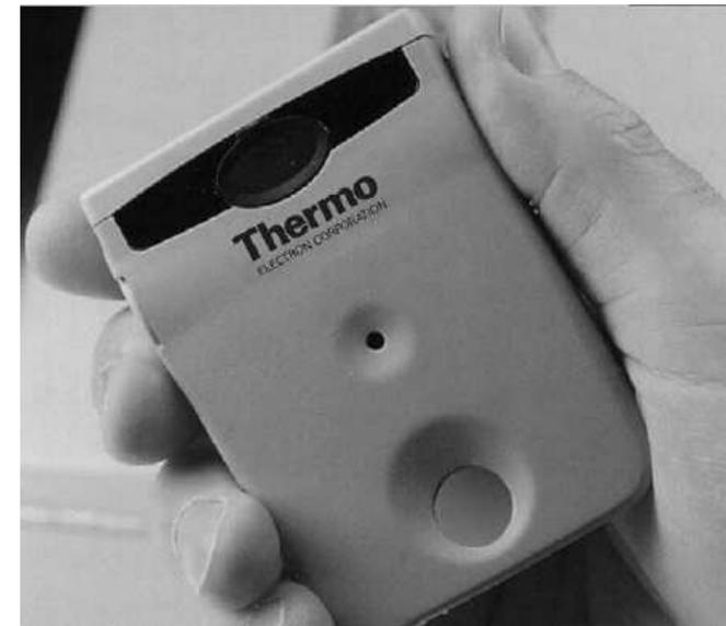
Se basa en el conteo de tres diodos polarizados en inversa como cámaras de ionización de estado sólido. Dos diodos tienen una lámina de plata y de estaño con un espesor másico similar para atenuar igualmente los rayos X (esto se hace así para poder medir la componente de neutrones y fotones en campos de radiación mixtos) . Los neutrones (de baja energía) interactúan con la plata produciendo activación y desintegraciones beta detectables ( $t_{1/2} \sim 144s$ ) (ver capítulo 2)
