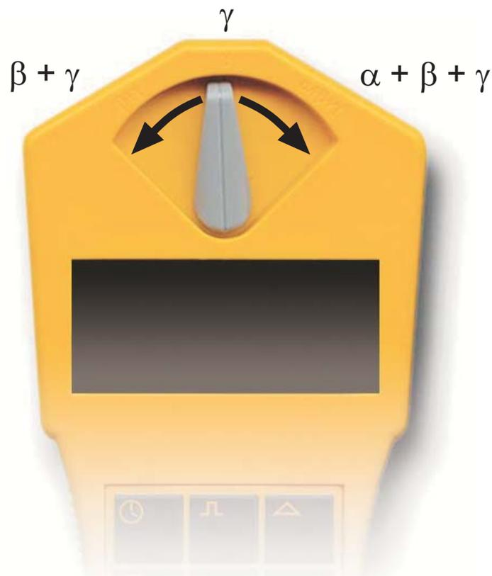
Dentro de su funcionamiento estándar, el GAMMA-SCOUT le informa de manera rápida y segura de la carga radioactiva actual. La así denominada dosis equivalente se calcula en la actualidad con el factor de 95,00 [impulsos por minutos /  $\mu\text{Sv}$  por hora] de los impulsos determinados por tiempo, factor válido para el rango de medición del GAMMA-SCOUT.
