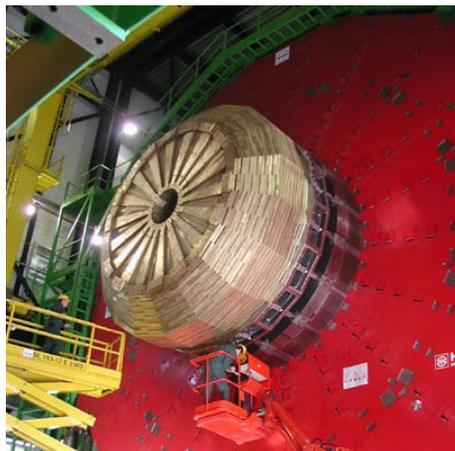
Figura 2.10: Una de las tapas del calorímetro hadrónico. [57]
