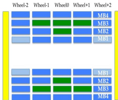
Imagen 4.5. Esquema de los voltajes en 2018. En verde DTs a 3600 V, en azul oscuro a 3550 V y en azul claro a 3500 V. FET=20 mV. Tomada de [25].
