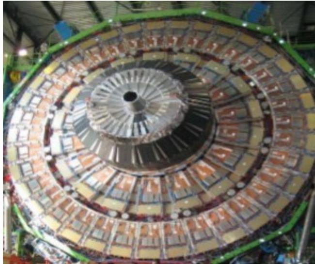
*Imagen 3.4. CSCs montadas en la zona del endcap.
